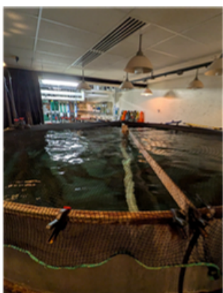
De gauche à droite: Bassins circulaires 2000 L double drains, bassin circulaire 20 000 L double drains, aquariums 10 gallons et bassins suédois 180 L.
