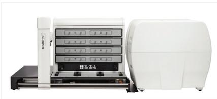
BioSpa 8 Incubateur Automatisé et Cytation Imageur Cellulaire Multi-Mode pour l'automatisation complète des dosages cellulaires.
